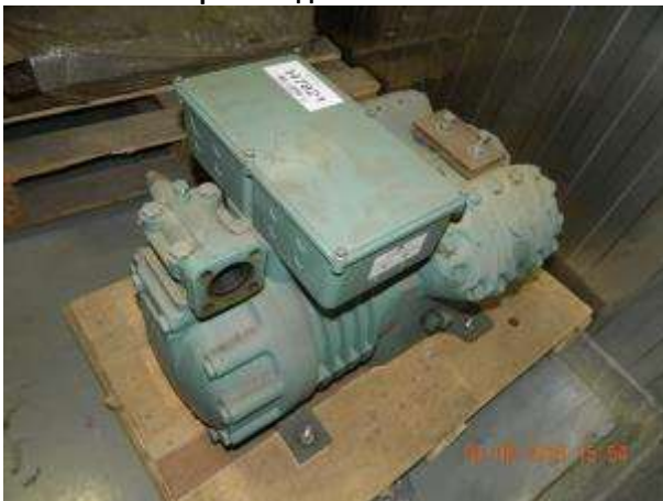
Фото 189 Компрессор Bitzer 4H-15.2-40P
