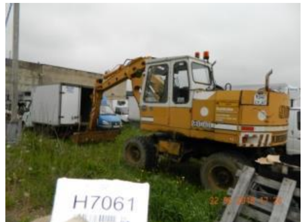
Фото 434 Экскаватор колесный "LIEBHERR" однокошовой 9340
